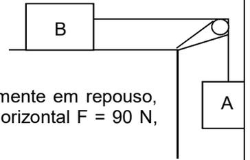
15. Dois blocos A e B, de massas respectivamente iguais a 5 kg e 10 kg, estão inicialmente em repouso, encostados um no outro, sobre uma mesa horizontal sem atrito. Aplicamos uma força horizontal  $F = 90 \text{ N}$ , como mostra a figura.
