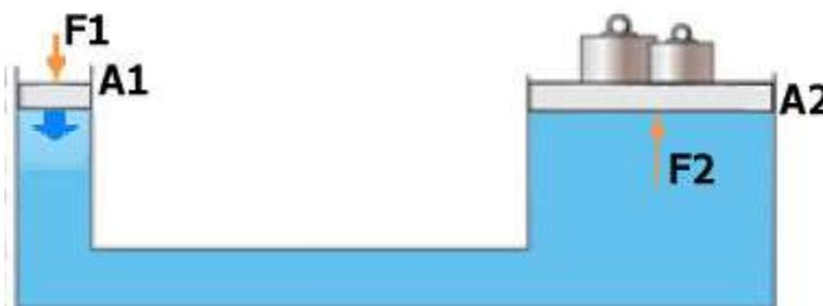
3. Um objeto de peso 2000 N é colocado sobre a área maior de um elevador hidráulico que possui valor de  $0,4 \text{ m}^2$ . Determine a mínima força necessária a ser aplicada sobre a área menor, de valor  $4 \times 10^{-4} \text{ m}^2$ , para que o objeto possa ser elevado.
