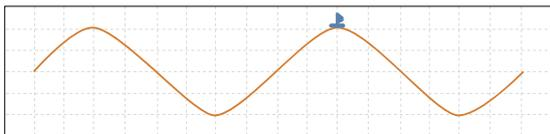
Sabendo que cada quadradinho possui 1,0 m de lado, determine o comprimento de onda.
