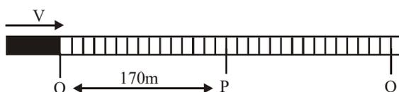
A partir do ponto O, o trem apita três vezes, sendo uma vez a cada 2,5 segundos (instantes  $t = 0,0$  s,  $t = 2,5$  s e  $t = 5,0$  s.) Um observador que está parado no ponto P, ao lado da ferrovia e a 170 m do ponto O, ouvirá os apitos do trem nos instantes:
